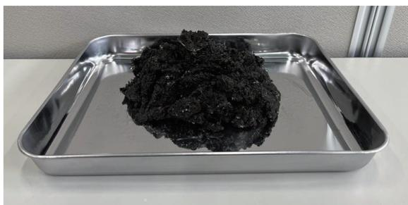
1分程度混合して泥の性状が変化したら改良が完了
