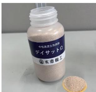
計量スプーンでデイサットをすくう。(1杯=3kg/m<sup>3</sup>)
